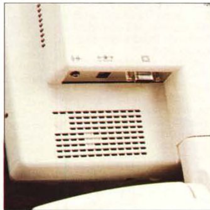
Il pannello connessioni, nella parte bassa dello schermo, vede, oltre al connettore video VGA, il connettore dell'alimentazione DC e un mini-jack per l'audio stereofonico.
